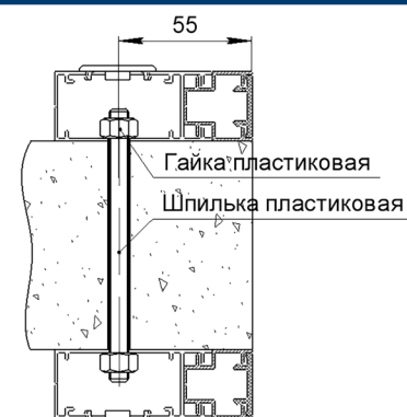
Рис. 6.5. Установка на внутреннюю алюминиевую раму
